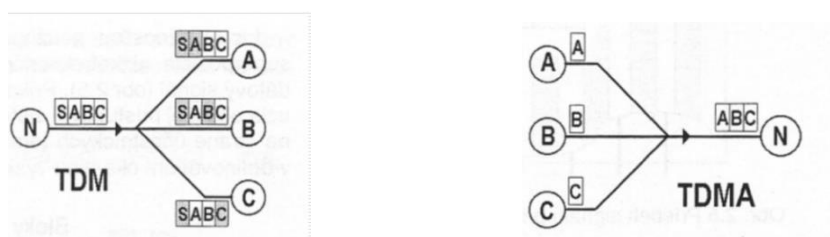
Obr. 2.6 Ilustrácia časovo deleného multiplexu (TDM) a prístupu na jeho princípe (TDMA).
