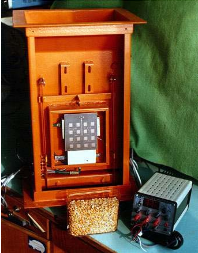
Obr. 6.7 Mikropásiková anténa na priebežné kontrolovanie vlhkosti obilia.
