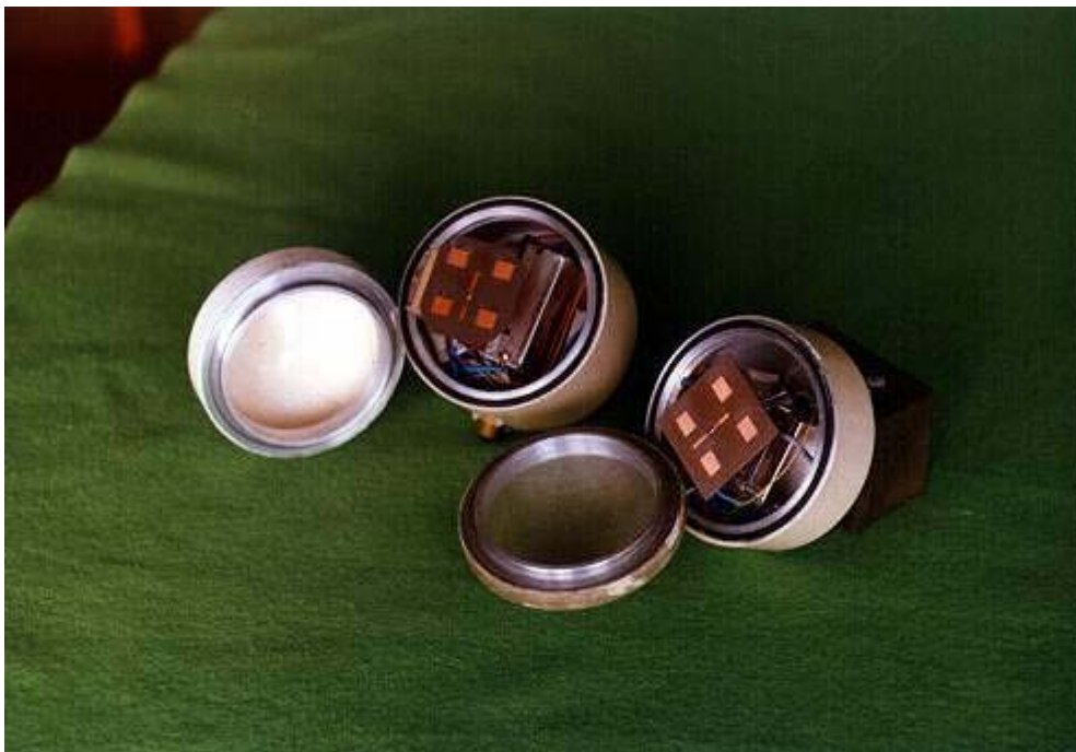
Obr. 6.6 Senzory obsahu vlhkosti textilu pracujúce na frekvencii 10,5 GHz (vstupná a výstupná jednotka).
